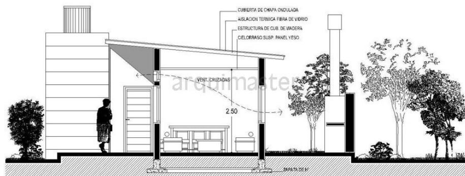
Figuras 197, 198, 199 e 200: Cortes das habitações com descrição dos materiais utilizados na construção e possibilidade de crescimento.
